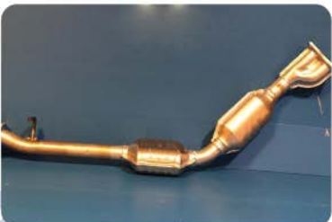
مجموعه لوله جلویی اکروز با کاتالیست دو تکه یورو ۴ دوگانه و بنزینی نیسان (زامیاد)
