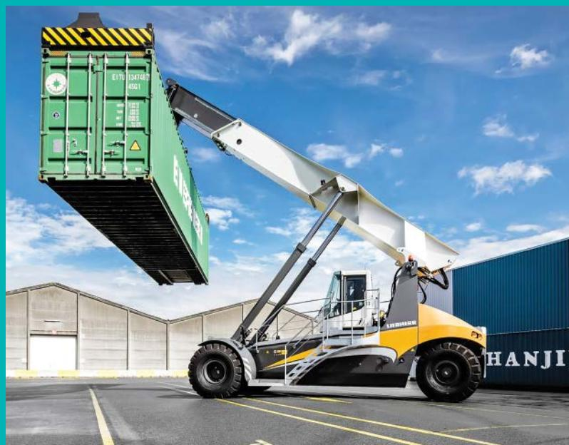
دلیل هم این تاسیسات را استراتژیک می‌دانند. دستگاه ریچ استکر انواع مختلفی دارد؛ ریچ استکر تاپ لیفت ۴۵ تن نوعی است که صنعت اندیشه مدار در حال ساخت آن است و پیچیده‌ترین مدل بین دستگاه‌های ریچ استکر است که می‌تواند تا ۴۵ تن بار را تحمل کند. این تجهیز کانتینر را سمت بالا گرفته و حمل می‌کند. به گفته ریاضی، پس از اتمام ساخت این مدل از دستگاه، شرکت اندیشه صنعت مدار برای کامل کردن این سبد محصولات خود اقدام به تولید مدل‌های دیگر از محصول خواهد کرد.
