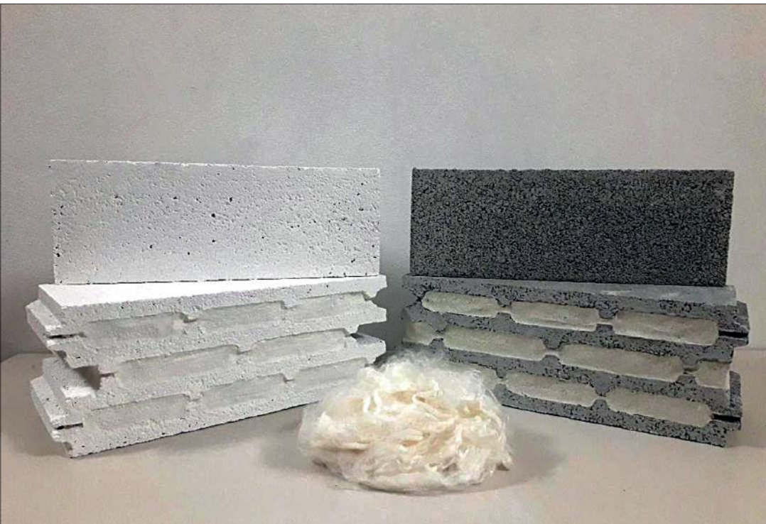
بتون سمت چپ با استفاده ازآب پسماند صنایع لبنی تولید شده است
